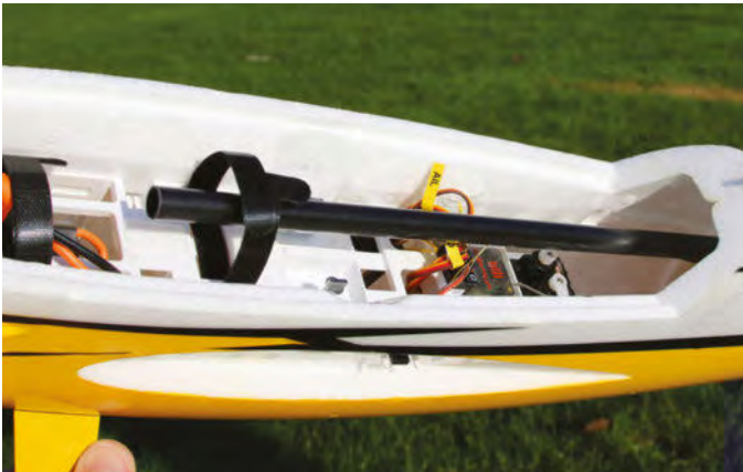
Bien vu: un logement est prévu dans le fuselage pour mettre les clés d'ailes et de stabilisateur.
