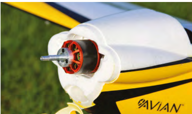
Le moteur brushless fournit une puissance de 500 W avec un LiPo 4S.
