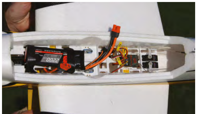
La grande bulle tient avec un verrou à ressort et assure un très bon accès.
