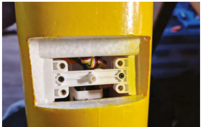
Le train en alu est vissé sur une structure en plastique.
