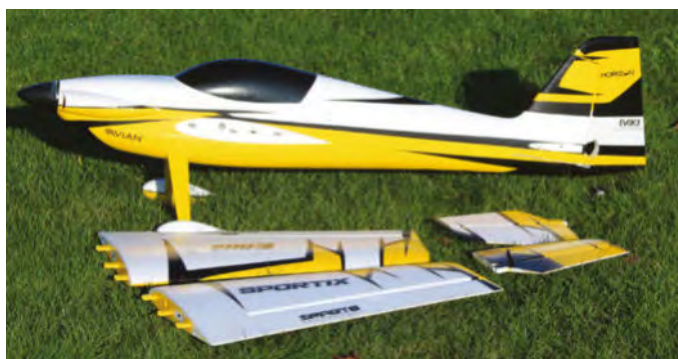
Avec ses ailes démontables sans outils et sa petite taille, le Sportix est un modèle pratique. Même le stabilisateur peut se démonter.
