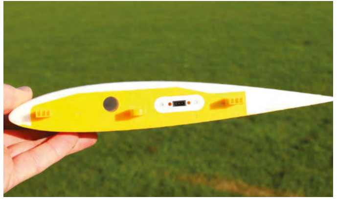
Le profil des ailes est un biconvexe dissymétrique. À l'emplanture, il y a une prise de servos qui se connecte automatiquement dans le fuselage: pratique!
