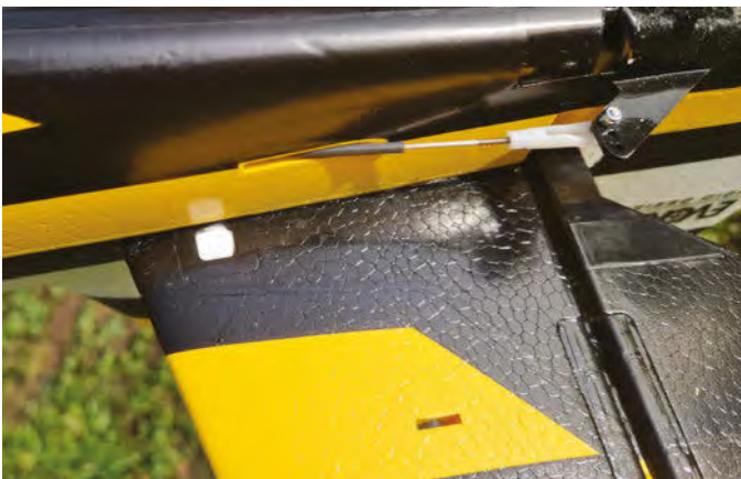
Pour démonter les demi-stabilisateurs, rien de plus simple: il suffit d'appuyer sur ce petit clip en plastique blanc.
