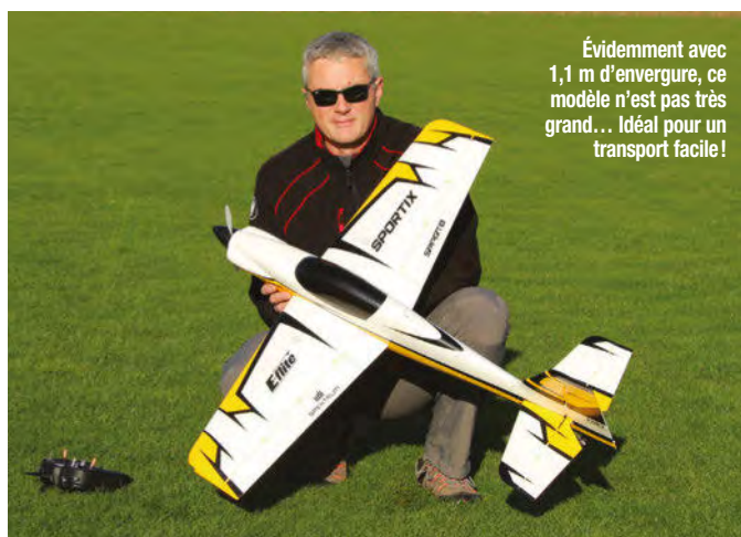
Avec ses ailes démontables sans outils et sa petite taille, le Sportix est un modèle pratique. Même le stabilisateur peut se démonter.
