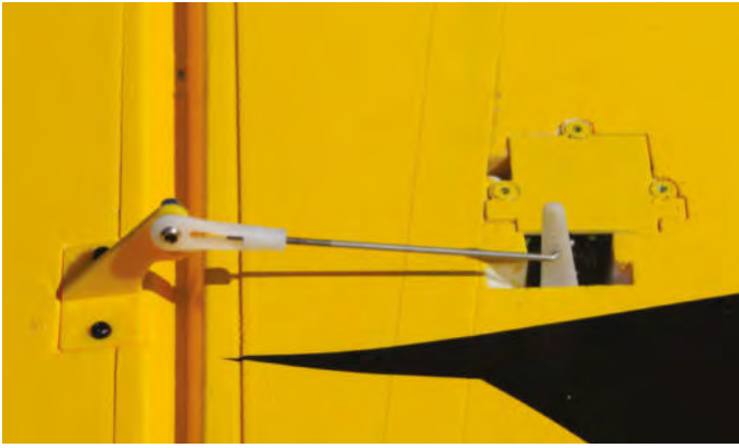
Les servos au format 9 g à pignons métal sont vissés (et non collés) dans les ailes. Ils seront donc démontables au besoin.
