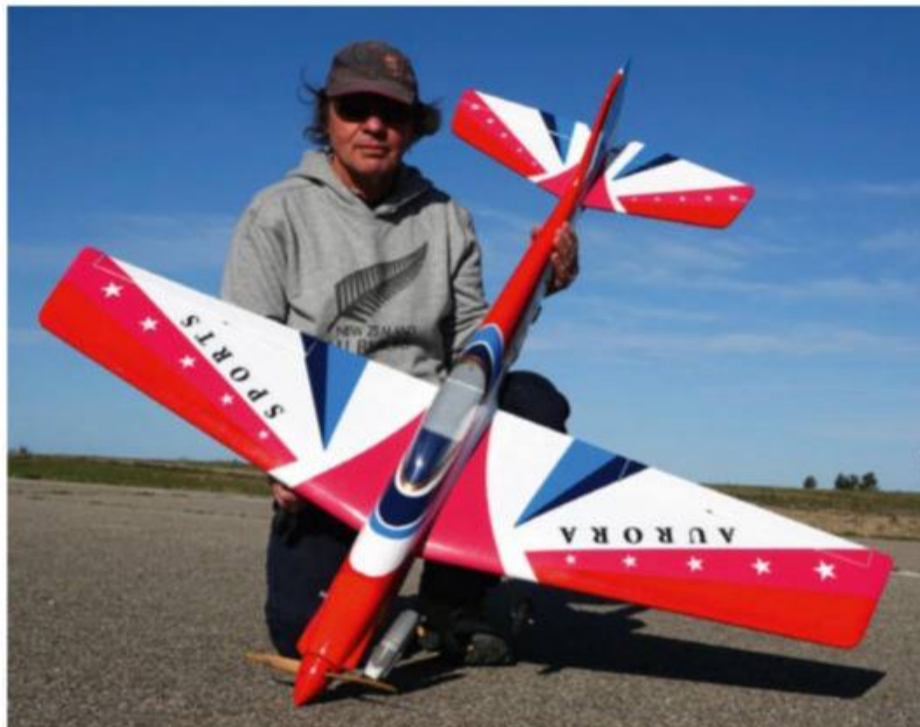
Le fuselage est assez fin avec une large dérive fixe: on est très loin des standards des voltigeurs modernes avec des fuselages énormes.
